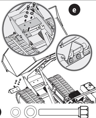
**DE- 5 & 6 )** Montieren Sie die Halterungsbasis mit zwei Schrauben und Unterlegscheiben. Montieren Sie die bereits montierte Pflugschar wie abgebildet an dem Raupenfahrwerk.
