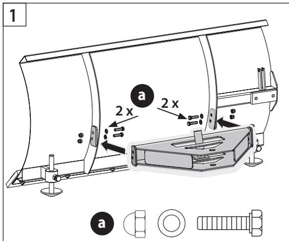
**DE- 1)** Montieren Sie die Halterung an der Klinge mit Sechskantschrauben, Unterlegscheiben und Muttern. **2)** Positionieren Sie den Schwenkbügel innerhalb des Montagebügels und richten Sie ihn an den Halterungslöchern aus.
