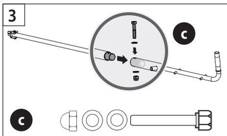
**DE- 3)** Setzen Sie den kürzeren Steuerhebel in den längeren Hebel ein. Richten Sie die Löcher aus und befestigen Sie sie mit Sechskantschraube, Unterlegscheiben und Mutter. **4)** Befestigen Sie den Steuerhebel am Führungsrohr. Die Löcher ausrichten und mit Schraube, Unterlegscheiben und Mutter befestigen. Den Griff in die Halterung einsetzen. Befestigen Sie die Halterung am Steuerhebel mit Stift und Brückenclip.
